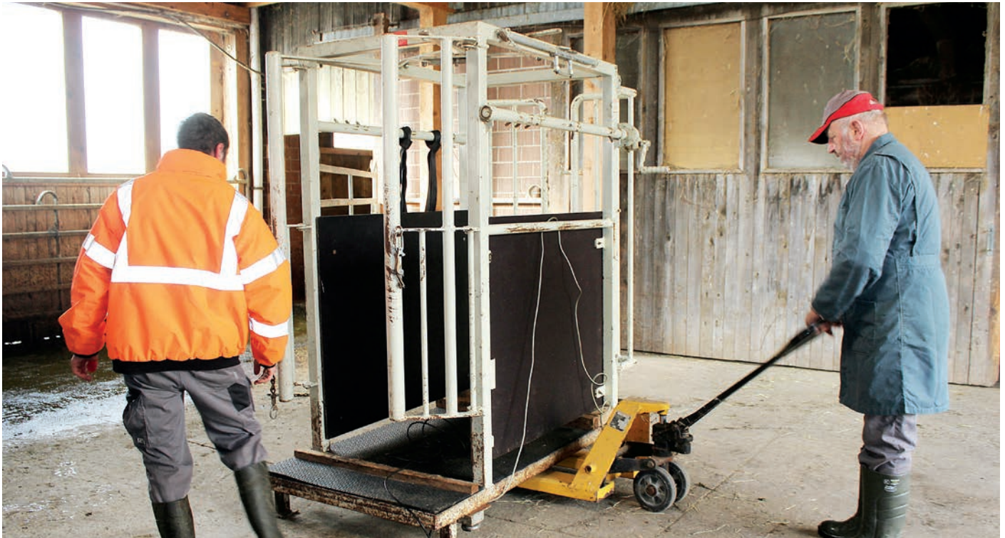
Gabriel (links) und Peter Müller schätzen die einfache Handhabung ihres Wiegesystems. Es besteht aus zwei Wiegebalken, die unter den Behandlungsstand geschoben werden.
