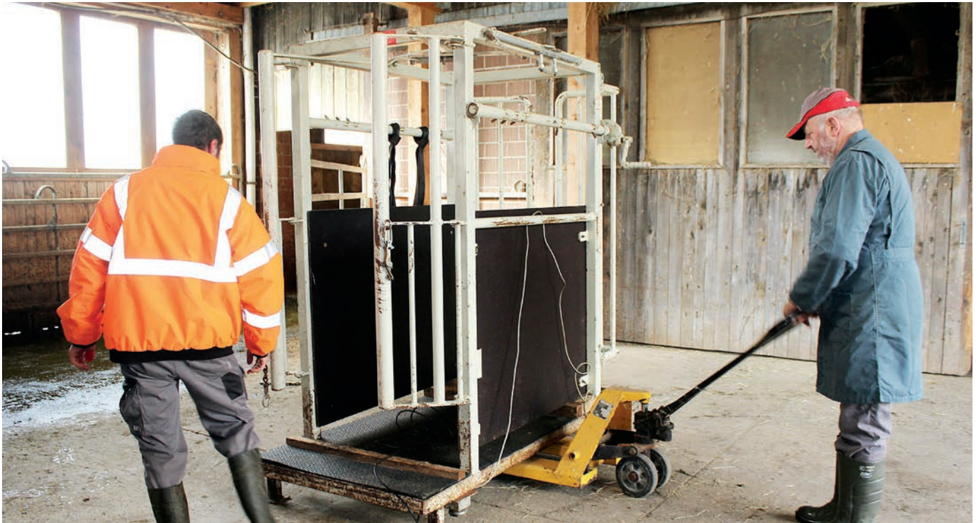
Gabriel (à gauche) et Peter Müller apprécient la facilité d'utilisation de leur balance. Elle est constituée de deux fléaux de balance que l'on introduit sous la cage de contention.
